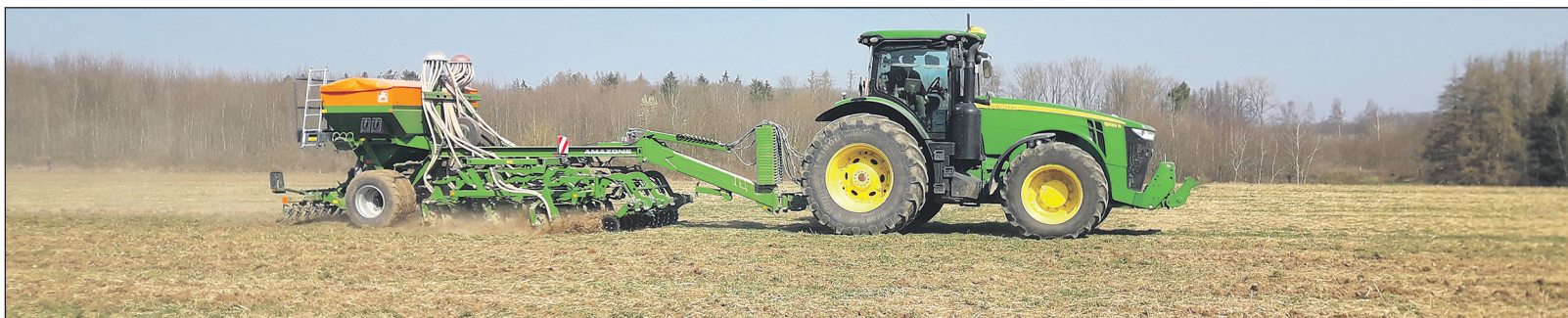
Mit dem Projektpartner Amazone werden aufbauend auf der Sämaschine Typ Primera DMC notwendige Vorwerkzeuge entwickelt, die einen geeigneten Saathorizont für die Hauptkultur schaffen. Fotos: C. Mittermeier
